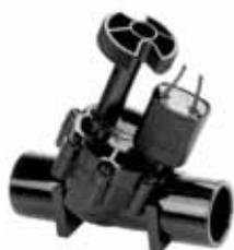
✓ O design inclinado da Válvula PRO 100, possibilita uma menor perda de carga que as tradicionais válvulas de globo.
